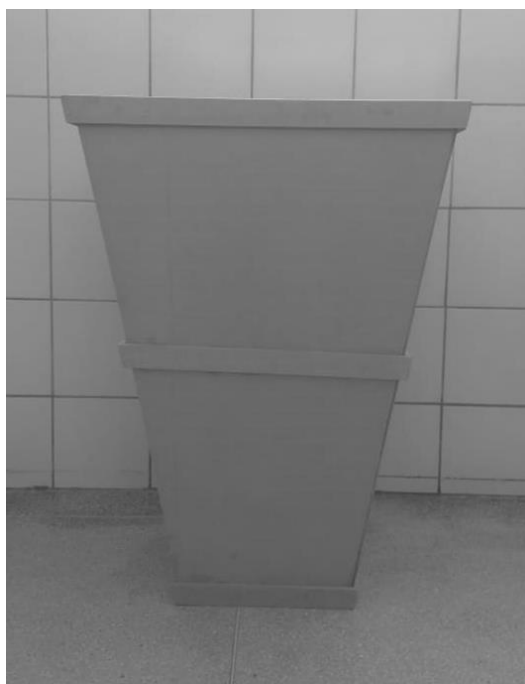
Figura 2 – Difusor confeccionado em capa de madeira.
