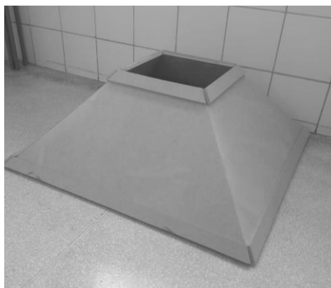
Figura 1 – Bocal confeccionado em capa de madeira.
